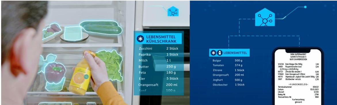
Abbildung 31: Veranschaulichung der Produkterkennung im Kühlschrank mit Hilfe von im Kühlschrank installierten Kameras (links) und der Fusion der erkannten Produkte mit den abfotografierten, digitalisierten Kassendaten (rechts) zum Aktualisieren des Haushaltsbestands.
