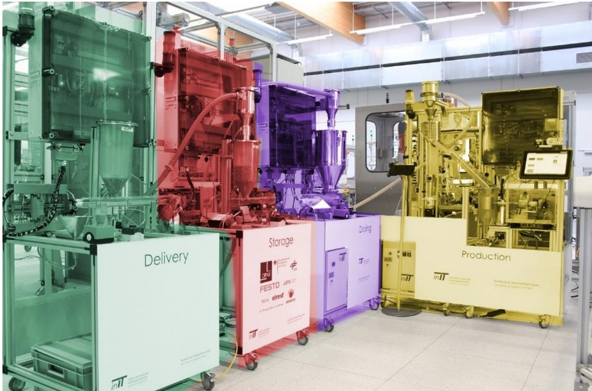
Abbildung 10: Abbildung des Versatile Production System in der SmartFactoryOWL
