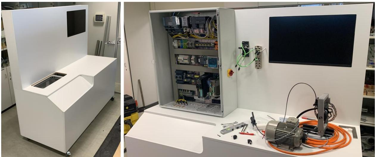
Abbildung 27 Verkleidetes Demonstrator-Gestell (links) und Befestigung erster Komponenten am Demonstrator (links)
