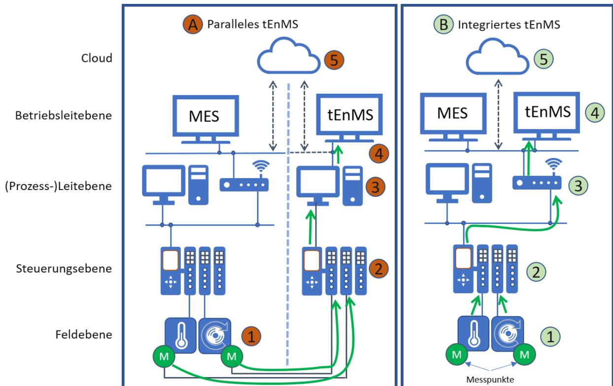
Abbildung 3: Ausführungen des technischen Energiemanagements, basierend auf [35]
