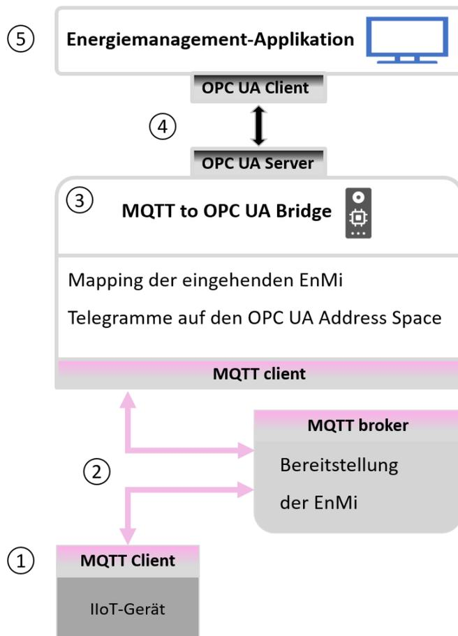
Abbildung 13: MQTT-to-OPC UA-Bridge, basierend auf [7]
