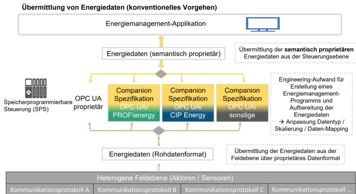
Abbildung 1: Übermittlung von Energiedaten mittels des konventionellen Vorgehens
