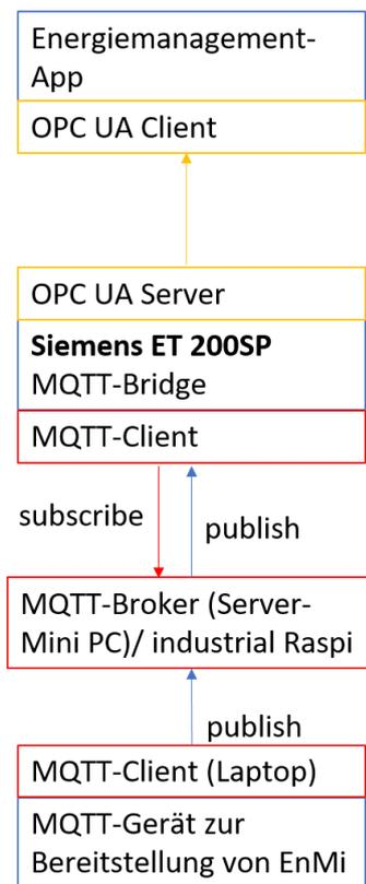
Abbildung 14: Umsetzung einer MQTT-to-OPC UA-Bridge auf der Referenzplattform
