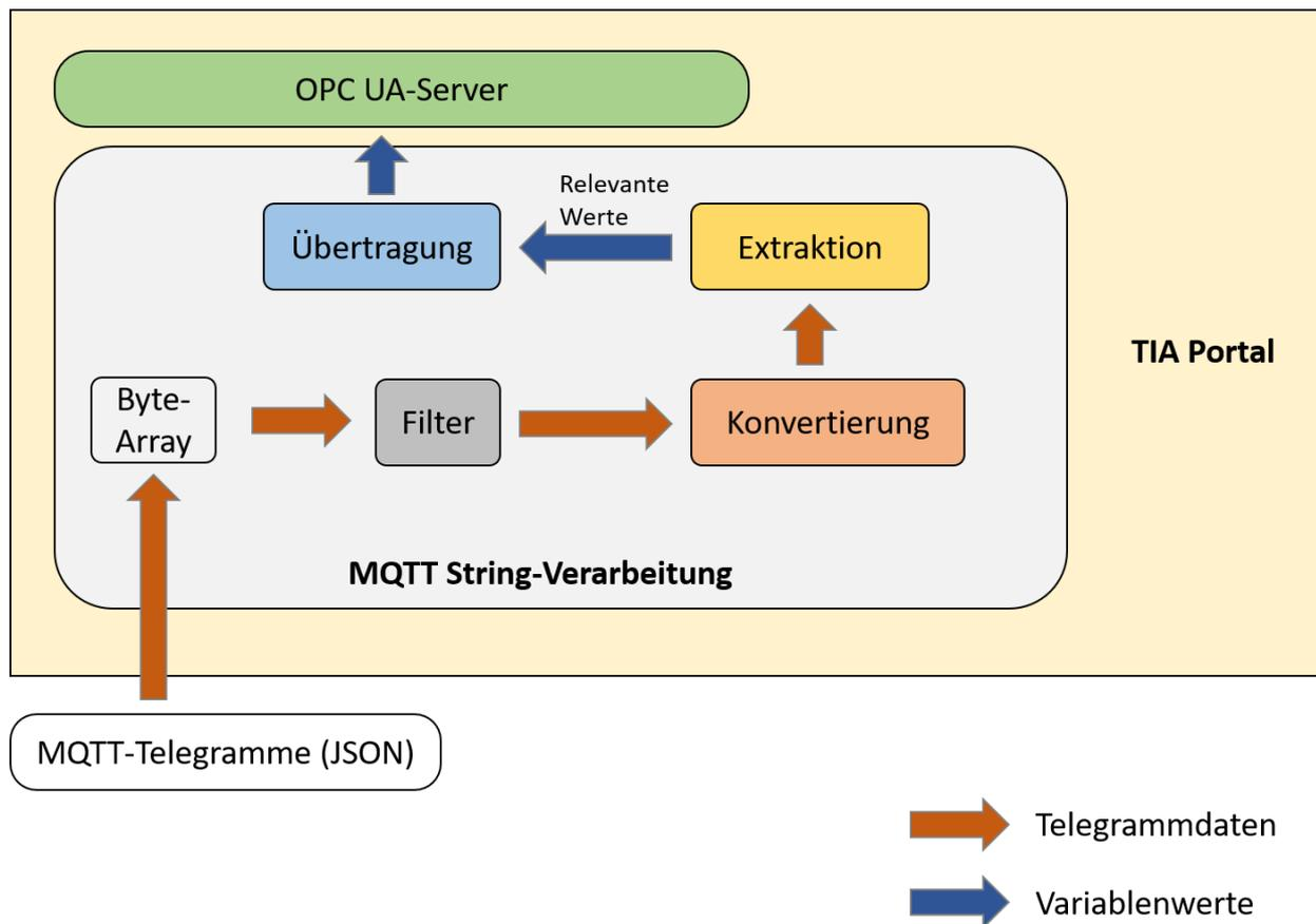
Abbildung 15: Analyse und Verarbeitung der Energiedaten im SPS-Programm
