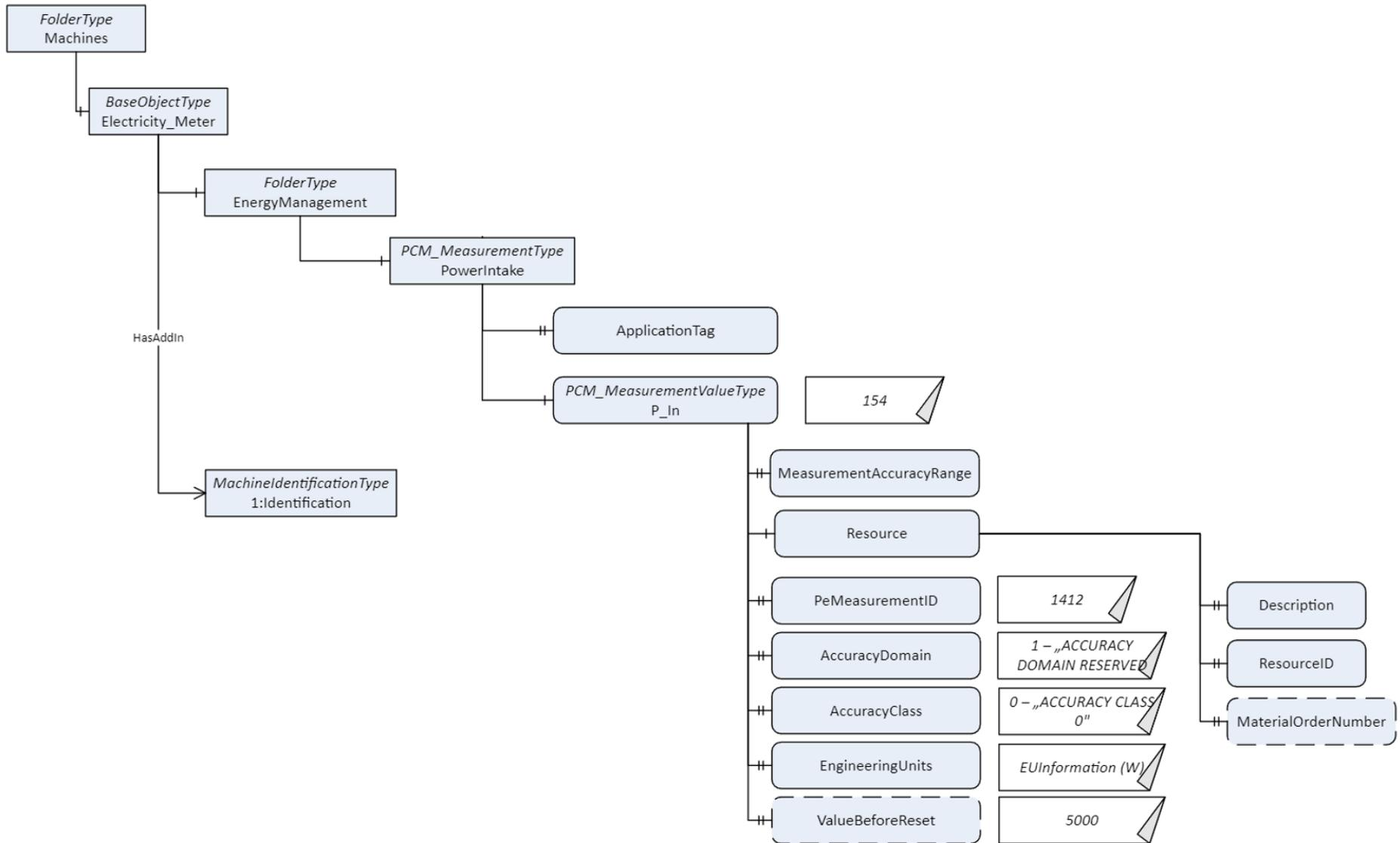
Abbildung 9: Modellierung des universellen Energieinformationsmodells
