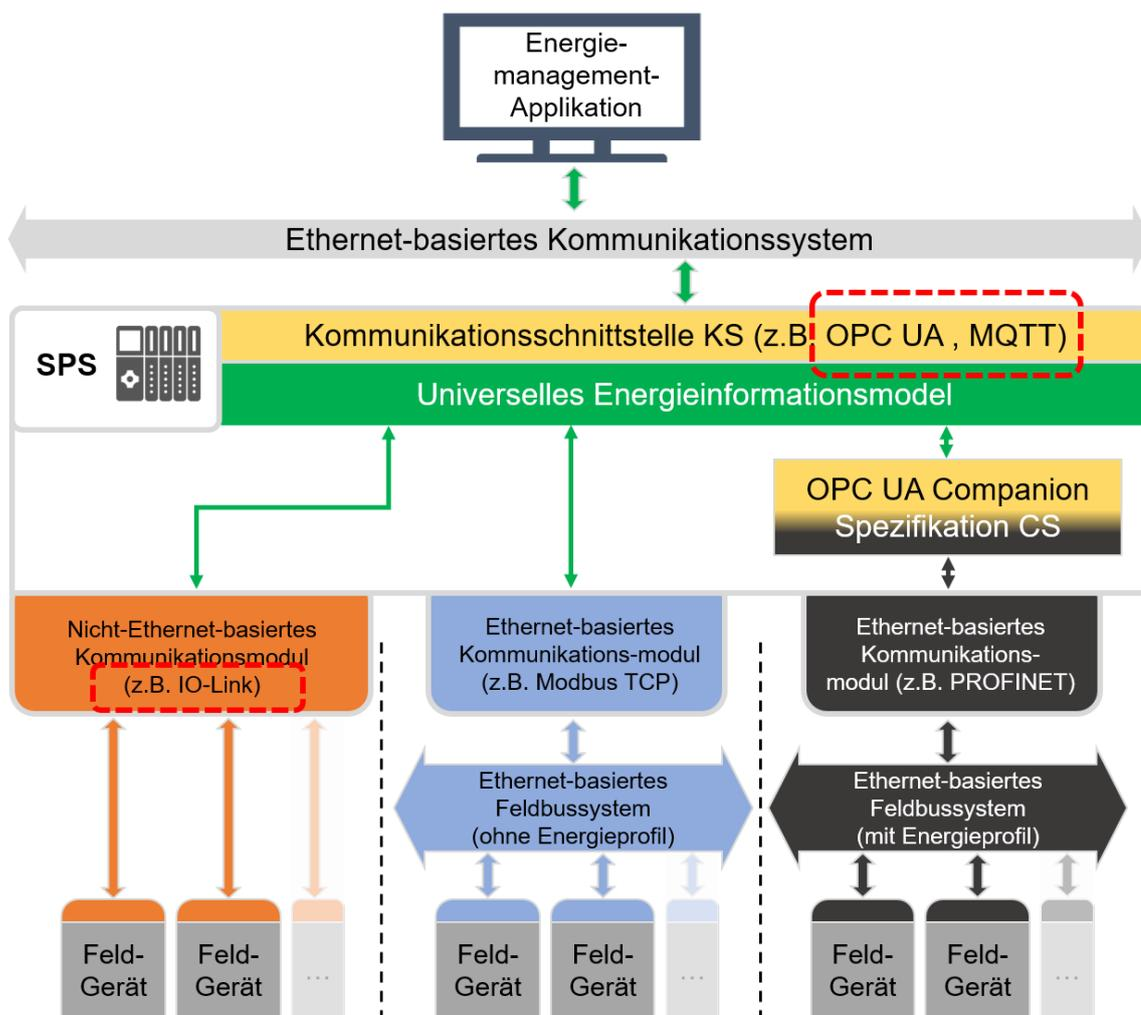
Abbildung 18 Energieinformationsmodell im industriellen Kommunikationsumfeld
