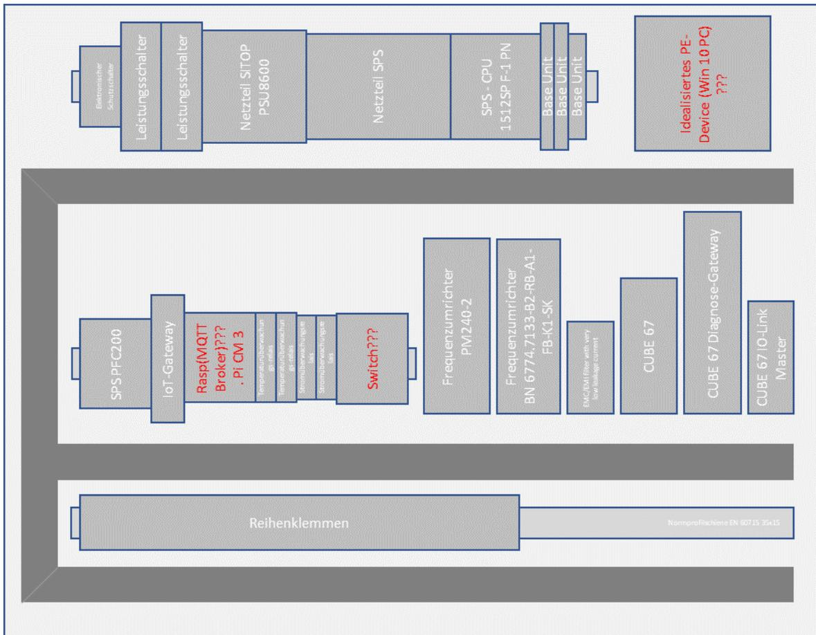
Abbildung 24 Planung und Aufbau des Schaltschranks
