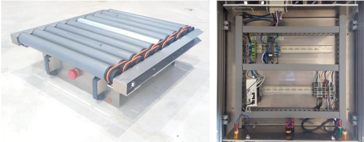
Abbildung 17: Umsetzung eines Fördermoduls und seiner Steuerung
