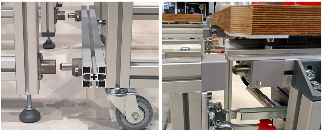
Abbildung 21: Modifikation der Modulaufnahmen. Altes (links) und neues (rechts) Konzept zum Ausrichten des Transportwagens vor der Modulaufnahme für die Durchführung des Modulwechsels
