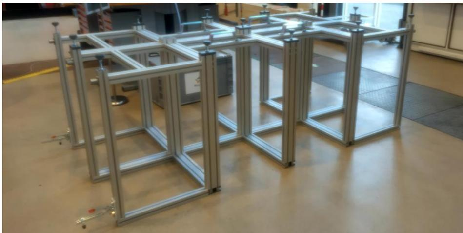
Abbildung 18: Zusammenbau des Rahmens. Hier noch in der Konfiguration mit seitlichem Moduleinschub.
